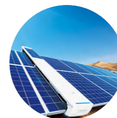
光伏智能清扫 系统
